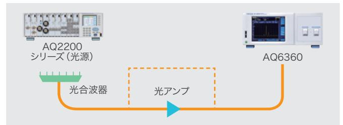
光ファイバーアンプ測定システムの例
