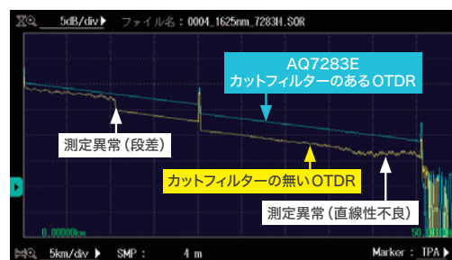
現用回線の OTDR 波形例
