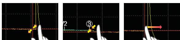
ピンチアウト 波形の拡大 ピンチイン 波形の縮小 ドラッグ コーソルの移動
