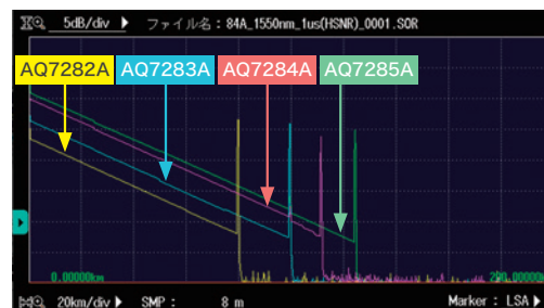
パルス幅 1 \mu s の OTDR 波形例
