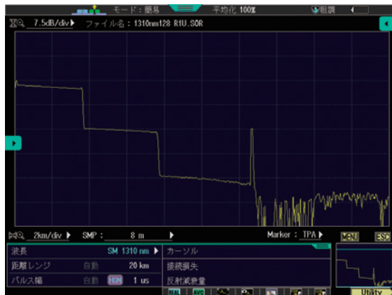
HSNモードにて128分岐を測定した例
