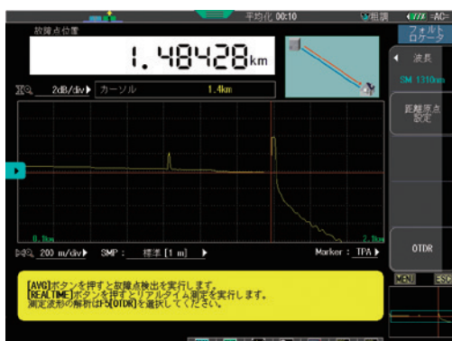
1.48km先の破断点を検出した例
