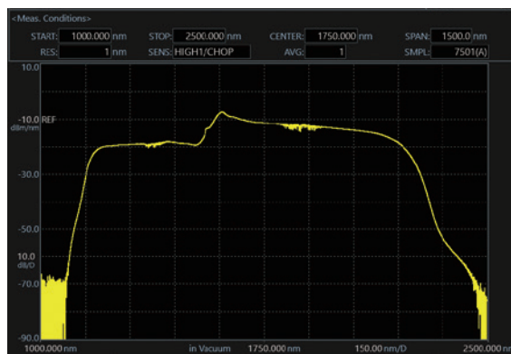
2 \mu m帯スーパー・コンティニウム光源の測定例 (波長拡大モデル使用)
