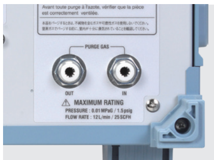
パージガス給排気口
