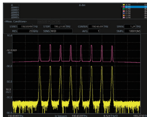
図2. 2種類の測定波形の表示例 (AQ6370E) 光アンプ入力信号(黄色)と増幅された信号(紫)
