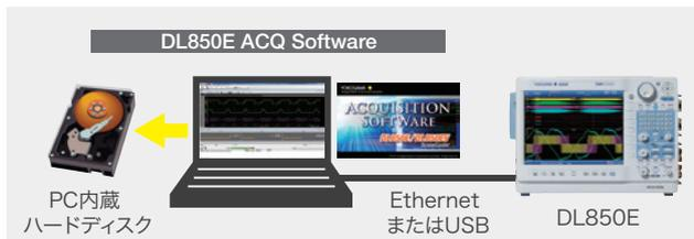
PCに接続されたDL850E/DL850EVとプラグインモジュールを自動認識します。複雑な設定をしなくても測定開始ボタンをクリックするだけですぐに測定を開始できます。システム構築、測定条件、記録条件、表示の詳細設定は5つのウィザード画面で簡単に設定できます。もちろん設定の保存/読み込みも可能です。
