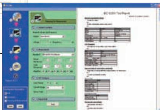
測定条件の設定画面 IEC62301規格に沿って、測定時間、規格の設定やアルゴリズムのパターンを選択します。
