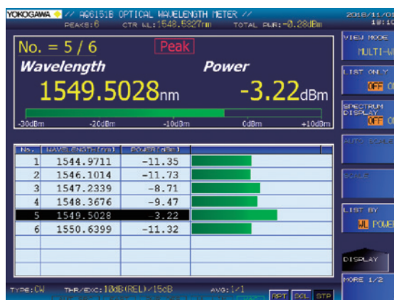
光パワーはバーグラフでも表示されるので、パワーのばらつきや平坦性を視覚的に確認できます。
