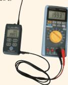
長期ロギングや複数接続可能なデータロガーとの接続 (98077 出力ケーブル(ネジ端子用)とデータロガーとの接続例)
