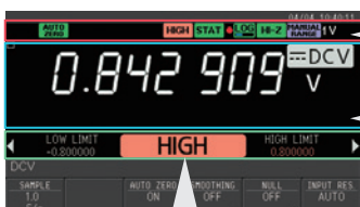
アナンシエータ 機器の動作状態をアイコン表示します。
