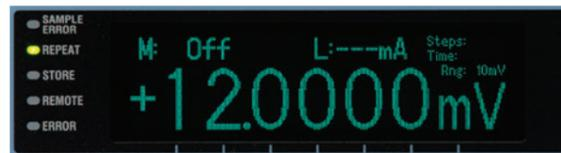
±120,000表示カウント、最小100nVステップの高分解能出力
