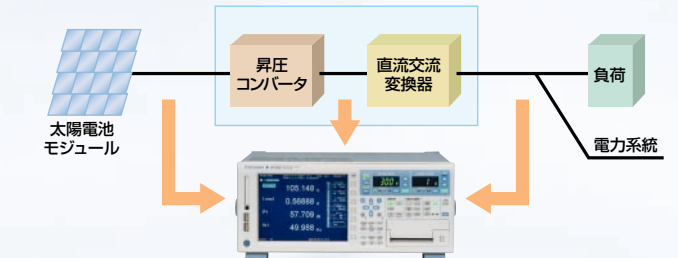
パワーコンディショナのシステム例 (太陽光発電)
