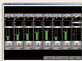
制御ブロック計器図を1画面に8個まで表示
