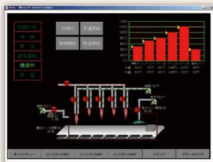
任意作成のグラフィック画面でプラント全体を操作監視。
