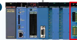
YHLSマスタモジュール 最大63スレーブ/系統
