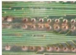
プリントパターンに腐食発生
