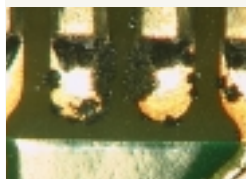
IC外部リードに腐食発生
