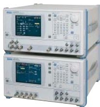
40Gbit/s 光伝送システム向け誤り率測定器 「AP9950 パルスパターンジェネレータ」 (上)と「AP9951 エラーディテクタ」(下)
